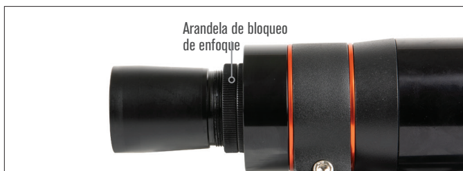
Fig. 22: Afloje la arandela de bloqueo cuando realice ajustes de enfoque, y apriétela firmemente cuando esté enfocado.
