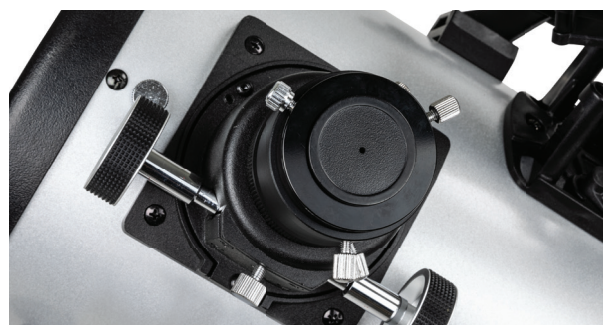
Figura 15: Per verificare l'allineamento degli specchi, utilizzare il tappo per collimazione in dotazione nel focheggiatore.
