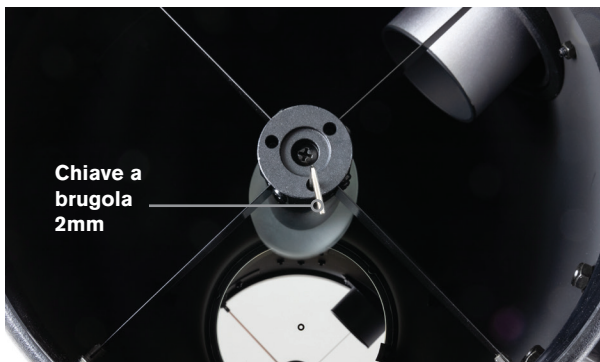
Figura 18: Le tre viti a brugola nel supporto dello specchio secondario regolano l'inclinazione dello specchio secondario.
