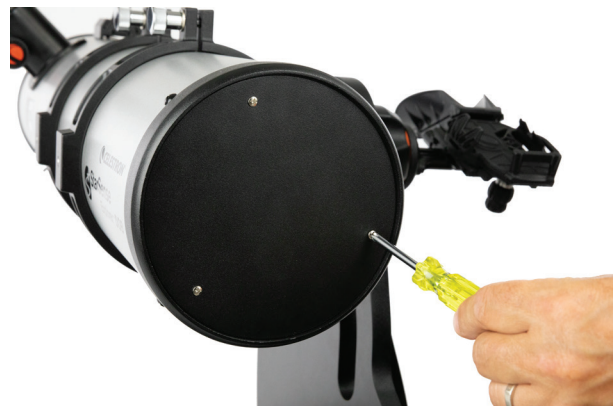
Figura 19a: Para el Dob Sobremesa 130, retire la cubierta posterior de la célula del espejo
