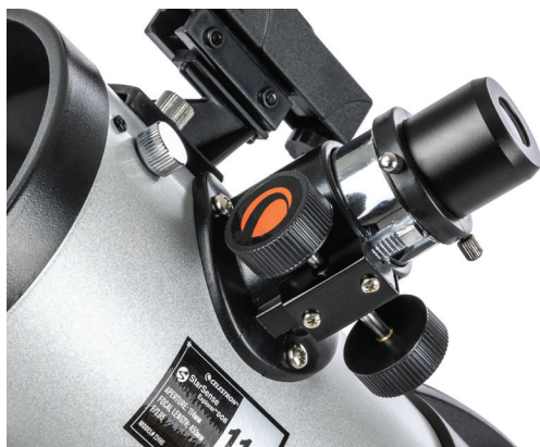
Figure 5: Fixez l'oculaire de 1,25 pouce dans le porte-oculaire avec les vis à main.
