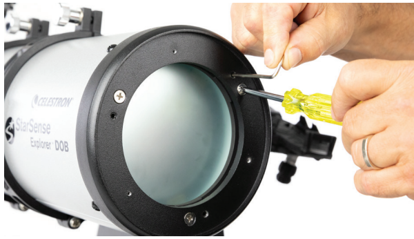
Figura 20: Para el Sobremesa Dob 130, dispone de tres grupos de tornillos de empuje-tiro en la célula del espejo que ajustan la inclinación del espejo primario. Afloje un tornillo del par y apriete el otro para ajustar la inclinación.
