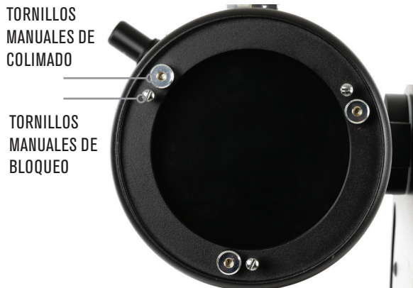
Figura 21: Los Sobremesa Dob 114 y 150, disponen de tres tornillos manuales con muelle de colimado que ajustan la inclinación del espejo primario. Los otros tres tornillos bloquean el espejo cuando haya terminado de realizar ajustes en su inclinación.
