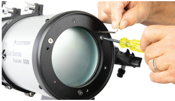
Figure 20: Pour le Tabletop Dob 130, trois jeux de vis de réglage dans la cellule du miroir permettent de régler l'inclinaison du miroir principal. Desserrez une vis de la paire et serrez l'autre pour régler l'inclinaison.
