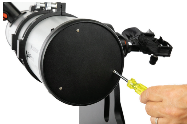
Figura 19a: Per il telescopio da tavolo Dob 130, rimuovere la copertura posteriore dalla cella dello specchio
