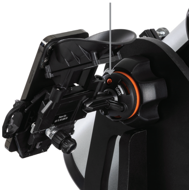
Abbildung 24: Um das StarSense-Dock von der Basis zu trennen, drücken Sie den orangefarbenen Verriegelungsknopf und drehen den Arm des Docks im Uhrzeigersinn.“
