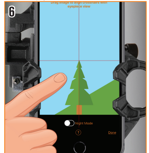
6. Desplace la vista de la cámara hasta que el mismo objeto esté centrado en el punto de mira.
