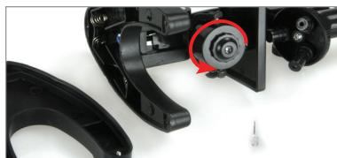
Il microscopio è dotato di una lampadina di ricambio per l'illuminatore. Per sostituire la lampadina rimuovere le batterie e ruotare l'illuminatore in modo da accedere alla lampadina. Ruotare l'anello intorno alla lampadina di 1/8 di giro in senso antiorario per sbloccarla. Estrarre l'anello per esporre la lampadina. Sostituire la lampadina e sistemare nuovamente l'anello spingendolo verso il corpo dell'illuminatore e ruotandolo in senso orario per bloccarlo in posizione.
