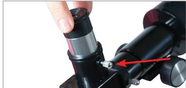
Allentare la vite di regolazione della diagonale stellare e inserire un oculare da 10 mm (60x). Fissare in posizione l'oculare serrando la vite di regolazione sulla diagonale stellare.
