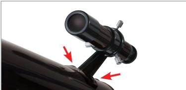
Per fissare il cercatore, rimuovere innanzitutto i due dadi posti in cima al tubo del telescopio. Sistemare la staffa del cercatore sulle due aste filettate così esposte. Fissarlo in posizione riposizionando i due dadi; assicurarsi che l'estremità dell'oculare del cercatore sia rivolta nella stessa direzione dell'oculare del telescopio.
