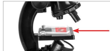
Insérez une lame préparée dans les valets de la platine du microscope.
