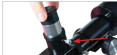
Afloje el tornillo de la diagonal estelar e introduzca el ocular de 10mm (60x). Asegure el ocular en posición fijando el tornillo de la diagonal estelar.
