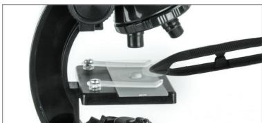
Découpez un petit morceau du sujet et déposez-le sur la lame. Utilisez le compte-gouttes pour déposer une petite goutte d'eau distillée et posez une lamelle sur le sujet d'observation. La goutte d'eau permet de tenir la lamelle en place. Une fois terminé, vous pouvez laver la lame pour la réutiliser.
