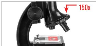
Ruotare la canna dell'obiettivo fino a quando 150x appare nella finestra di ingrandimento. La canna scatta in posizione una volta allineata correttamente.
