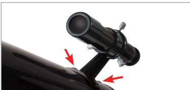
Para fijar el localizador, comience retirando las dos roscas situadas en la parte superior del tubo del telescopio. Coloque el soporte del localizador en los dos soportes estriados. Asegúrelo en posición sustituyendo las dos roscas, asegurándose de que el extremo del ocular del localizador esté orientado en la misma dirección que el ocular del telescopio.
