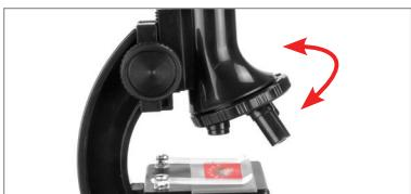
Per aumentare l'ingrandimento, ruotare il focheggiatore in modo che l'oculare sia sollevato alla massima altezza, ruotare quindi la canna fino a quando la finestra di ingrandimento mostra 450x. Mettere nuovamente a fuoco spostando il microscopio lentamente verso il basso fino alla messa a fuoco. Ripetere la procedura per 900x.
