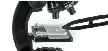
Tagliare una porzione del campione e sistemarlo sul contagocce, versare una goccia di acqua distillata sul campione e aggiungere un vetrino di copertura sul campione. L'acqua manterrà il vetrino di copertura in posizione. Al termine, è possibile lavare il vetrino e la copertura per un nuovo utilizzo.
