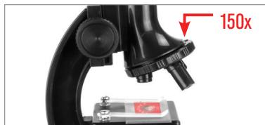
Drehen Sie den Objektivrevolver, bis im Vergrößerungsfenster 150x erscheint. Der Revolver rastet mit einem Klicken ein, wenn er korrekt ausgerichtet ist.
