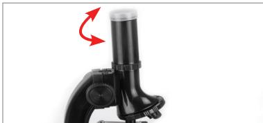
Pour utiliser votre microscope, retirez le capuchon de l'oculaire et faites tourner la molette de mise au point de manière à ce que l'oculaire soit remonté au maximum.
