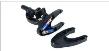
Ihr Mikroskop wird vollständig montiert geliefert, doch zur Verwendung der integrierten Beleuchtung müssen Sie zwei AA-Batterien einsetzen. Entfernen Sie dazu die drei Kreuzschlitzschrauben unter den Bodenplatte. Ziehen Sie die Platte vom Mikroskopsockel. Setzen Sie die Batterien unter Beachtung der korrekten Polarität in das Batteriefach ein. Bringen Sie Sockelplatte und Schrauben wieder an.
