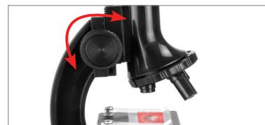
Regardez dans l'oculaire et faites tourner la molette de mise au point lentement pour faire descendre la lentille de l'objectif vers la lame et ainsi obtenir la meilleure netteté possible. Faites attention de ne pas faire descendre le microscope trop bas, car l'objectif pourrait entrer en contact avec la lame et endommager cette dernière ou le microscope.
