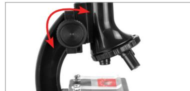
Guardare attraverso l'oculare e ruotare lentamente la manopola di messa a fuoco per abbassare l'obiettivo verso il vetrino fino a raggiungere una messa a fuoco nitida. Fare attenzione per evitare di spingere troppo in basso il microscopio fino a toccare il vetrino con l'obiettivo; in tal caso potrebbero verificarsi danni al vetrino o al microscopio.
