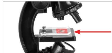
Führen Sie einen Objekträger in die Klammern des Mikroskopstells ein.
