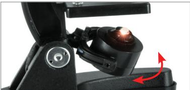
Ilumine el portamuestras con el espejo para reflejar la luz de una lámpara u otras fuentes de luz hacia el microscopio o girando la estructura de la bombilla hacia arriba hasta que se encienda. Apunte la fuente de luz inclinando el espejo/estructura de la luz hasta que la vista en el ocular quede iluminada de forma homogénea.
