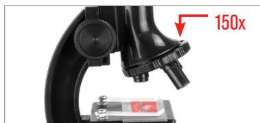
Faites pivoter l'objectif de la lentille jusqu'à ce que 150x apparaisse dans la fenêtre de grossissement. La tourelle émettra un déclic lorsque l'alignement est correct.
