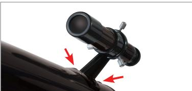
Zum Anbringen des Suchers die beiden Muttern oben am Teleskopbus lösen. Platzieren Sie die Sucherhalterung über den freigelegten Gewindestiften. Bringen Sie die Muttern zum Sichern wieder an. Achten Sie darauf, dass die Ausrichtung des Okularendes des Suchers mit der des Okulars am Teleskop identisch ist.
