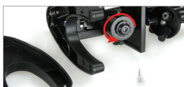
Votre microscope est livré avec une ampoule de rechange pour l'éclairage. Pour changer l'ampoule, retirez les piles et faites tourner l'éclairage de manière à pouvoir accéder à l'ampoule. Faites tourner l'ampoule d'1/8ème de tour dans le sens horaire pour déverrouiller l'anneau. Soulevez l'anneau pour découvrir l'ampoule. Remplacez l'ampoule et remettez l'anneau en place en le poussant vers l'éclairage et en le faisant tourner dans le sens horaire pour le verrouiller.
