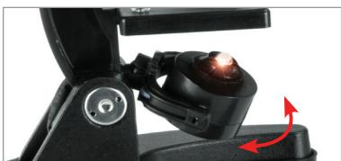
Illuminez la lame à l'aide du miroir permettant de refléter la lumière d'une lampe ou autre source lumineuse ou en faisant pivoter le bloc d'éclairage vers le haut jusqu'à ce qu'il s'allume. Orientez la source lumineuse en faisant pivoter le miroir ou le bloc d'éclairage jusqu'à ce que la vue dans l'oculaire soit éclairée de manière homogène.
