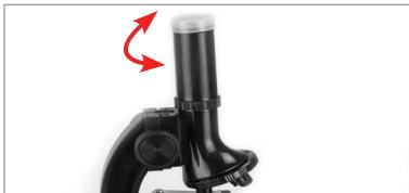
Zum Verwenden Ihres Mikroskops die Okularkappe abnehmen und am Fokussierer drehen, bis das Okular ganz nach oben gefahren ist.
