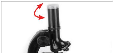
Per utilizzare il microscopio rimuovere il coperchio dalla lente dell'oculare e ruotare il focheggiatore in modo che l'oculare raggiunga l'altezza massima.
