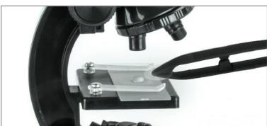
Corte un trozo pequeño del espécimen y colóquelo sobre el cuentagotas, ponga una pequeña gota de agua destilada sobre él y añada una tira de cubierta encima. El agua mantendrá la tira de cubierta en posición. Cuando termine puede lavar el portamuestras y la tira de cubierta para volver a usarlos.
