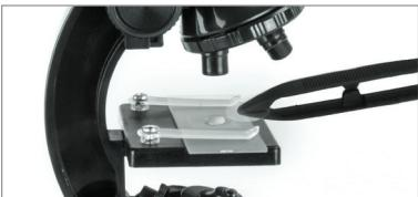
Schneiden Sie ein kleines Stück der Probe ab und legen Sie es mithilfe der Pipette auf das unter Glas. Bedecken Sie die Probe mit einem Tropfen destilliertem Wasser und legen Sie das obere Glas darauf. Das Wasser hält die Glasplättchen zusammen. Wird Ihre Probe nicht mehr benötigt, können Sie die beiden Glasplättchen waschen und für eine erneute Verwendung vorstauen.
