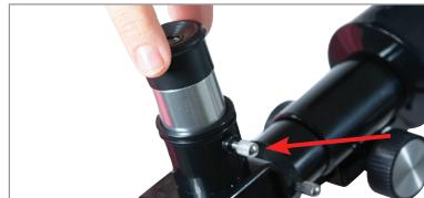
Lösen Sie die Stellschraube am Zenitspiegel und bringen Sie das 10-mm- (60x) Okular an. Ziehen Sie zum Sichern des Okulars die Stellschrauben am Zenitspiegel an.
