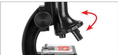
Para aumentar los aumentos, gire el enfoque de forma que el ocular se eleve a su posición más alta, y gire el soporte de lentes hasta que se muestre 450x en la ventana de aumentos. Enfoque de nuevo bajando lentamente el microscopio hasta lograr enfocar. Repita el procedimiento para 900x.
