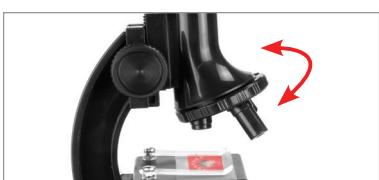
Pour augmenter le grossissement, faites tourner la molette de mise au point de manière à relever l'oculaire au maximum, puis faites tourner la tourelle jusqu'à ce que le chiffre 450x apparaisse dans la fenêtre de grossissement. Faites la mise au point de nouveau en abaissant le microscope lentement jusqu'à obtention de la netteté. Répétez la procédure pour le grossissement 900x.
