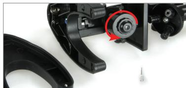
Im Lieferumfang Ihres Mikroskops ist ein Ersatzleuchtmittel für Ihre Beleuchtung enthalten. Zum Auswechseln des Leuchtmittels, die Batterien entnehmen und die Beleuchtung drehen, bis Sie das Leuchtmittel erreichen. Den Ring um das Leuchtmittel um 1/8 gegen den Uhrzeigersinn abdrehen. Den Ring nach oben abnehmen, um das Leuchtmittel freizulegen. Das Leuchtmittel austauschen, den Ring auf den Körper der Beleuchtungseinheit drücken und im Uhrzeigersinn festdrehen.
