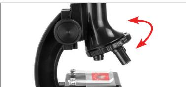
Für eine stärkere Vergrößerungsleistung am Fokussierer drehen, um das Objektiv ganz nach oben zu drehen, dann den Revolver drehen, bis im Vergrößerungsfenster 450x erscheint. Erneut fokussieren, indem Sie das Mikroskop langsam nach unten führen, bis Sie ein scharfes Bild erreicht haben. Wiederholen Sie dieses Vorgehen für die 900x Vergrößerungsleistung.
